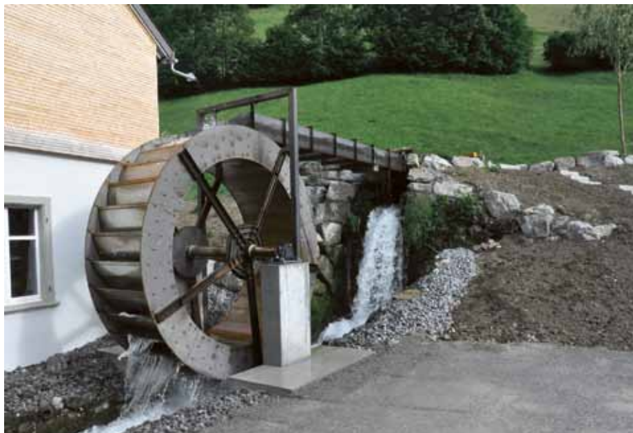
Das neue Wasserrad: Treibt die Transmission an und erzeugt eine maximale Leistung von 6,3 kW.
